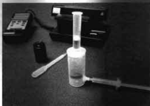
Abb. 1: Ausrüstungsbeispiel für die PAK-Bestimmung aus bitumenhaltigen Bindemitteln
